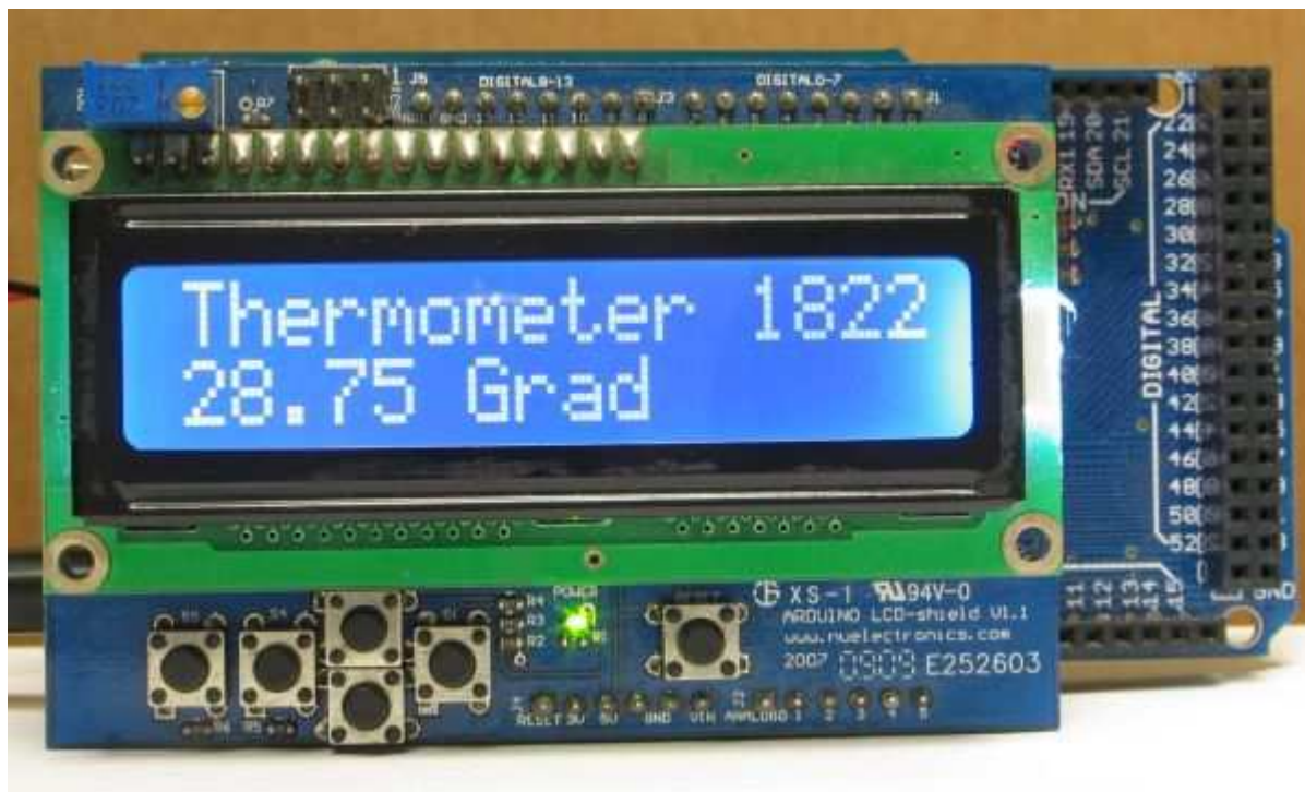
Fot. 12.1. Wygląd termometru z Arduino MEGA i wyświetlaczem ciekłokrystalicznym
