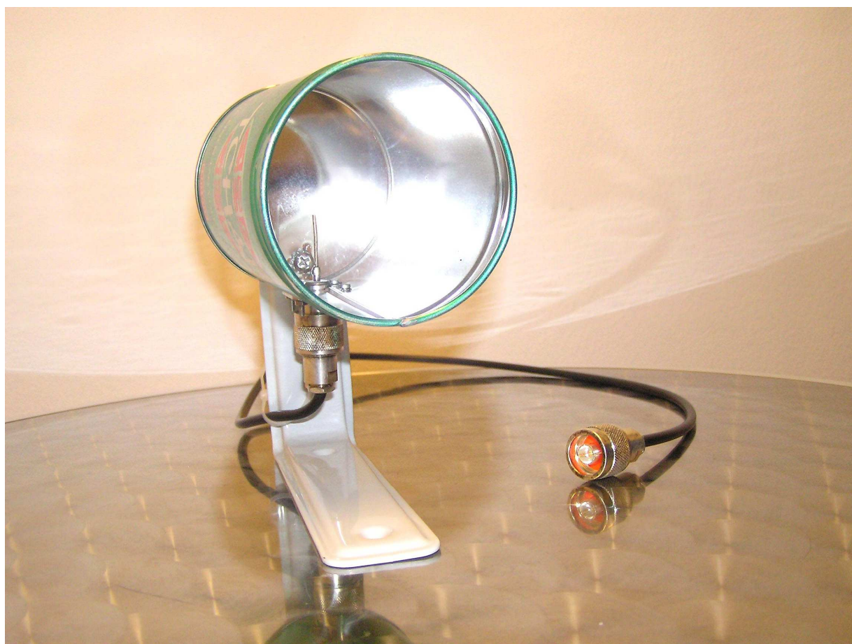
Rys. 6.5. Antena puszkowa OE1KDA na pasmo 13 cm. Antenka jest wykonana z przewodu miedzianego posrebrzanego.
