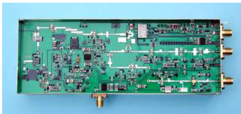
Fot. 3.14. Konstrukcja wewnętrzna transwertera – widok z góry
