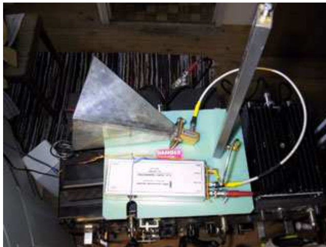
Fot. 3.29. Przykład konstrukcji stacji wyposażonej w tubową anteną nadawczą i szczelinową antenę odbiorczą podłączone bezpośrednio do modułu transwertera. Uniknięto w ten sposób konieczności użycia przełącznika antenowego
