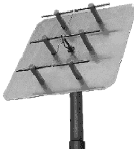
Fot 2.13. Fabryczna antena panelowa firmy „Wimo” o wymiarach 22 x 22 cm i jej konstrukcja wewnętrzna. Producent podaje dla niej zysk 9 dBd i szerokości wiązki 54° w pionie oraz 67° w poziomie. Parametry anten „Wimo” podano w tabeli w dalszej części skryptu
