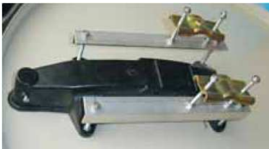
Fot. 3.8. Sposób montażu czaszy
