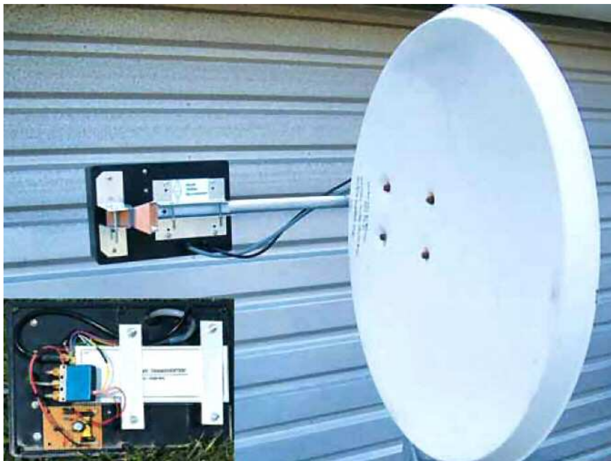
Fot. 3.1. Konstrukcja mechaniczna stacji na pasmo 10 GHz. W lewym dolnym narożniku wnętrza obudowy transwertera
