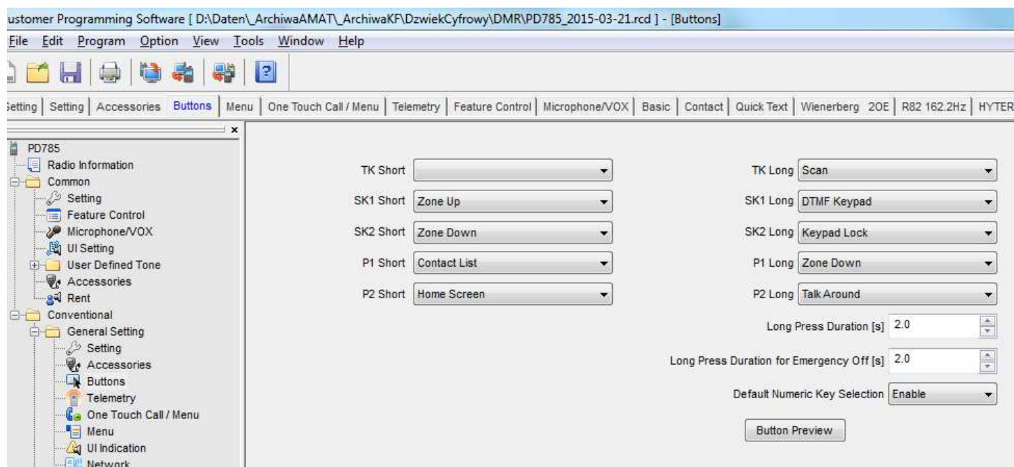
Rys. 5.17. Konfiguracja klawiszy programowalnych, punkt „Buttons” („Klawisze”) w grupie funkcji ogólnych („General Setting”). Funkcje klawiszy wybiera się z rozwijanych list dla długiego i krótkiego przyciśnięcia
