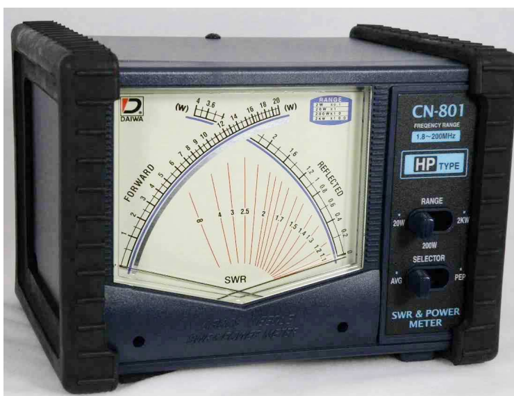
Rys. 6.4. Reflektometr ze skrzyżowanymi wskazówkami. Wartość WFS jest odczytywana na czerwonych rozchodzących się gwiazdźście liniach, bez konieczności kalibracji. Równoległe odczytywane są moce fali padającej (podpis. FORWARD ) i odbitej (podpis. REFLECTED ). W pozycji przełącznika AVG mierzona jest średnia moc nadawanego sygnału, a w pozycji PEP – moc szczytowa
