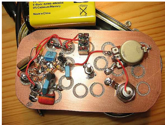
Fot. B.4. Konstrukcja wysepkowa
