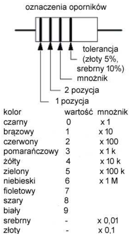
Rys. 1.3 Kodowanie wartości oporników za pomocą kolorów
