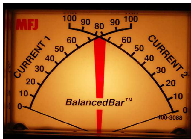
Rys. 6.9. Skala amperomierza do pomiaru symetrii linii. Wychylenie wskazówki poza czerwone pole wskazuje na wystąpienie nadmiernej różnicy prądów płynących w obu przewodach linii
