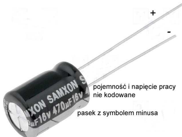
Rys. 1.6. Wyprowadzenia i oznaczenia kondensatorów elektrolitycznych
