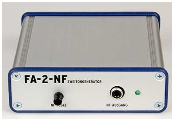
Fot. 7.2.6. Dwutonowy generator m.cz. do pomiaru nadajników SSB
