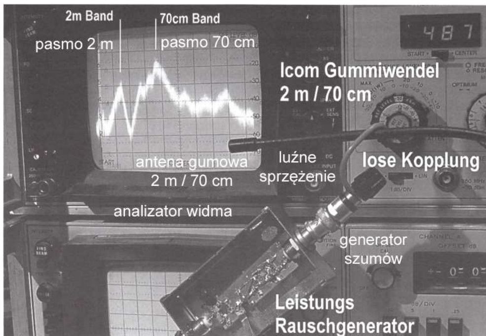
Fot. 6.7.2. Pomiar anteny i jej charakterystyka
