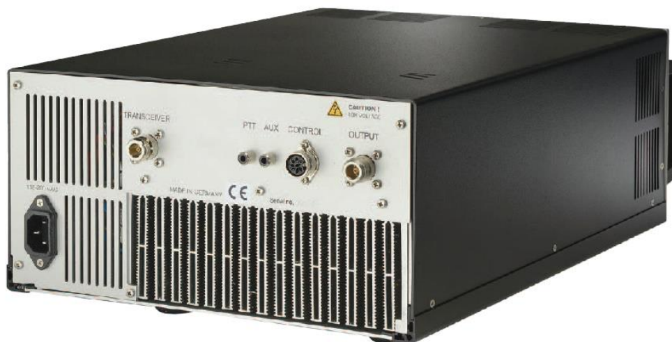
Fot. 14.2. W HLV-1100 zastosowano na wejściu i wyjściu gniazda N, a gniazdko foniczne do jego kluczowania. Gniazdko „CONTROL” pozwala na zdalne sterowanie wzmacniaczem
