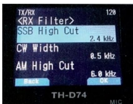
Rys. 1. Skomplikowane: dla wszystkich rodzajów modulacji można wybrać indywidualne szerokości pasma. Dla wąskopasmowej modulacji FM brakuje odpowiednio wąskiego filtra
