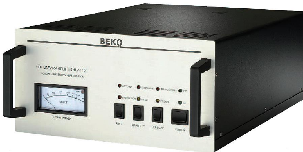
Fot. 14.1. W HLV-1100 zastosowano na wejściu i wyjściu gniazda N, a gniazdko foniczne do jego kluczowania. Gniazdko „CONTROL” pozwala na zdalne sterowanie wzmacniaczem
