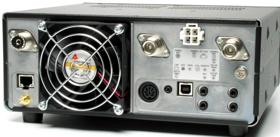
Fot. 2.2. Widok tylnej ścianki z rzucającym się w oczy dużym cicho pracującym wentylatorem i trzema gniazdkami antenowymi oddzielnymi dla każdego pasma. Gniazdko LAN pozwala na połączenie z siecią lokalną, SMA służy do podłączenia wzorca częstotliwości, a ACC – do sterowania dodatkowym wyposażeniem
