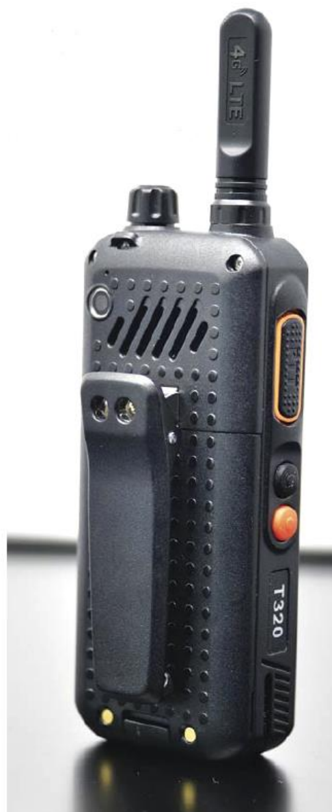
Fot. 9.2. Na tylnej ścianie widoczna jest kratka głośnika, a na lewej bocznej przyciski nadawania, migawki fotograficznej i alarmowy
