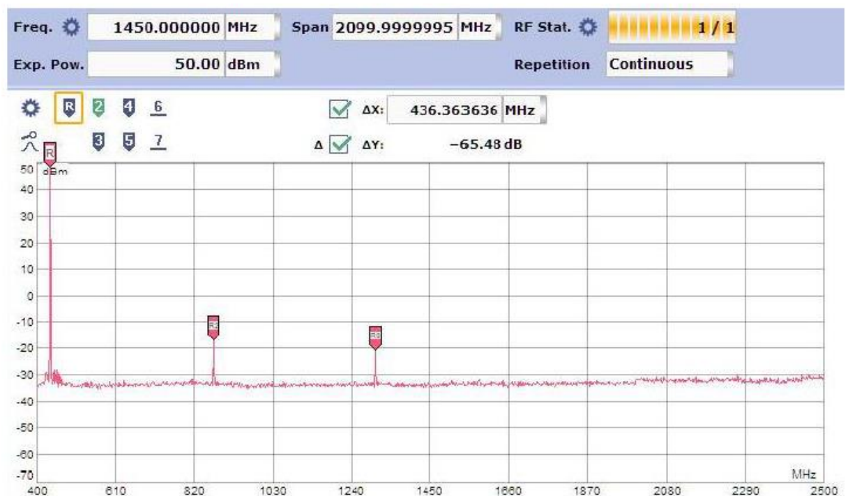
Fot. 1.8. Poziom niepożądanych składowych w paśmie 70 cm
