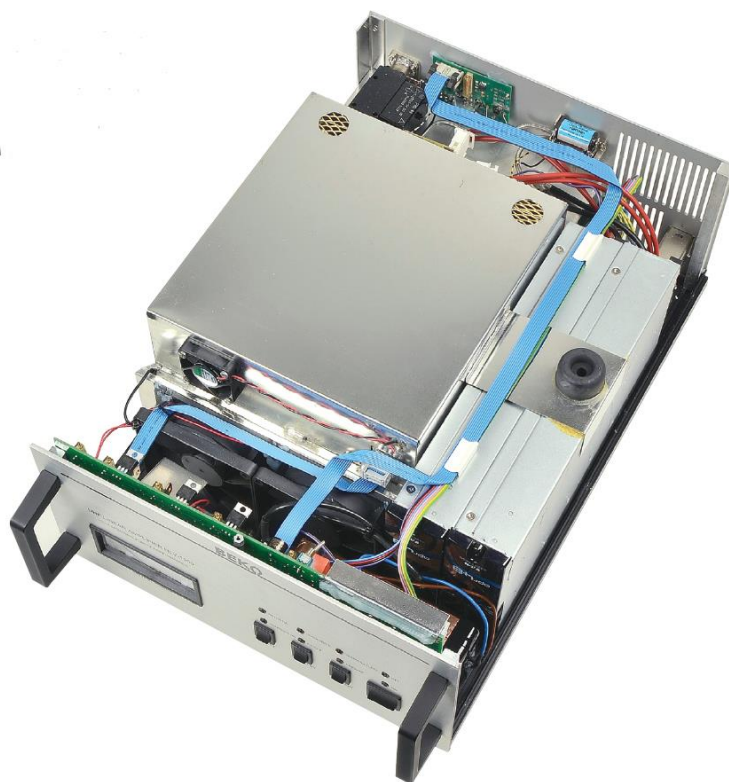
Fot. 14.3. Wewnątrz obudowy HLV-1100 znajduje się pudełko ekranujące. Potencjometry regulacji układów zabezpieczających umieszczono w górnej części płytki drukowanej znajdującej się z tyłu ścianki czołowej
