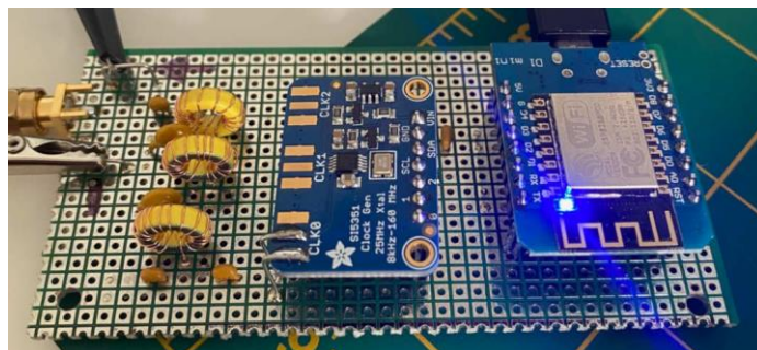
Fot. 4.1.5. Konstrukcja nadajnika WB2CBA na uniwersalnej płycie dziurkowanej
