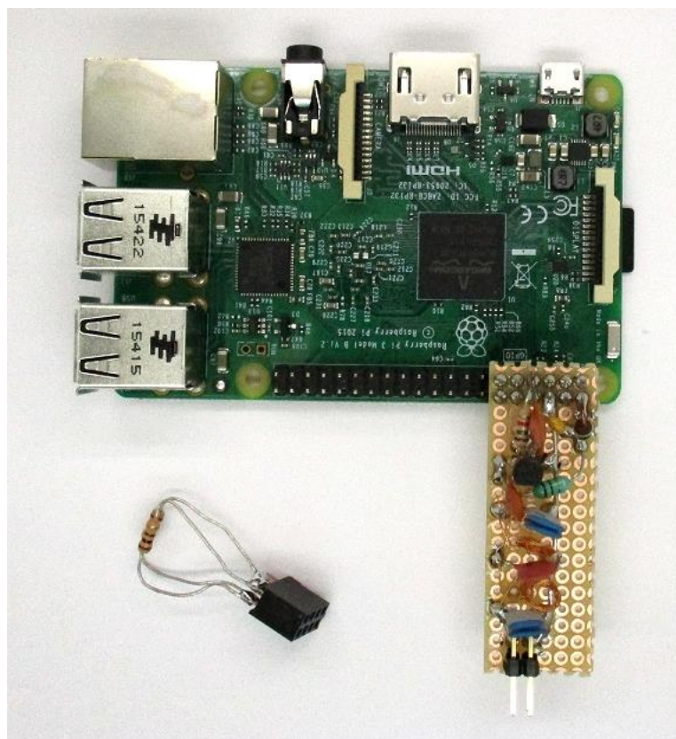
Fot. 4.2.8. „Malina” ze wzmacniaczem, po lewej stronie płytki wzmacniacza sztuczne obciążenie
