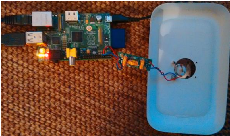
Fot. 4.2.2. Przykład konstrukcji nadajnika: od lewej do prawej kolejno Malina , filtr i obudowa z gniazdkiem antenowym.
