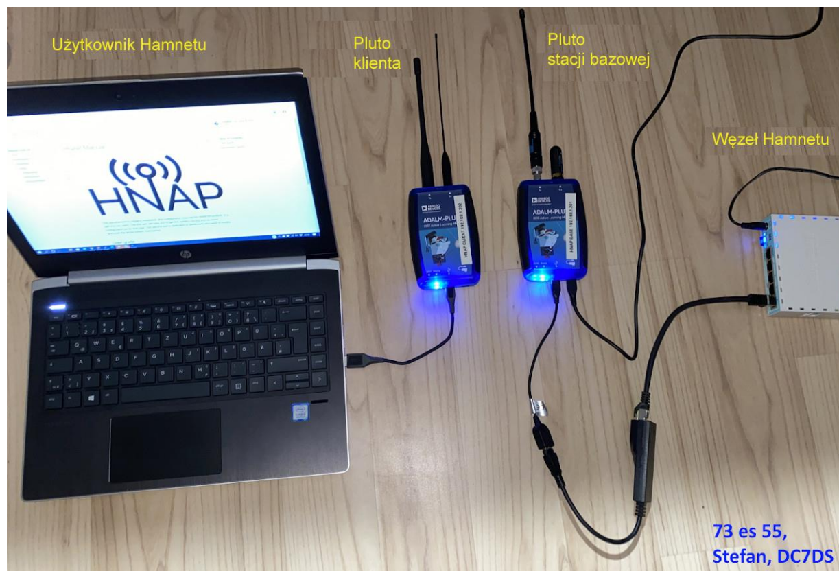
Fot. 14.2. Łącze z wykorzystaniem radiostacji „Adalm Pluto”
