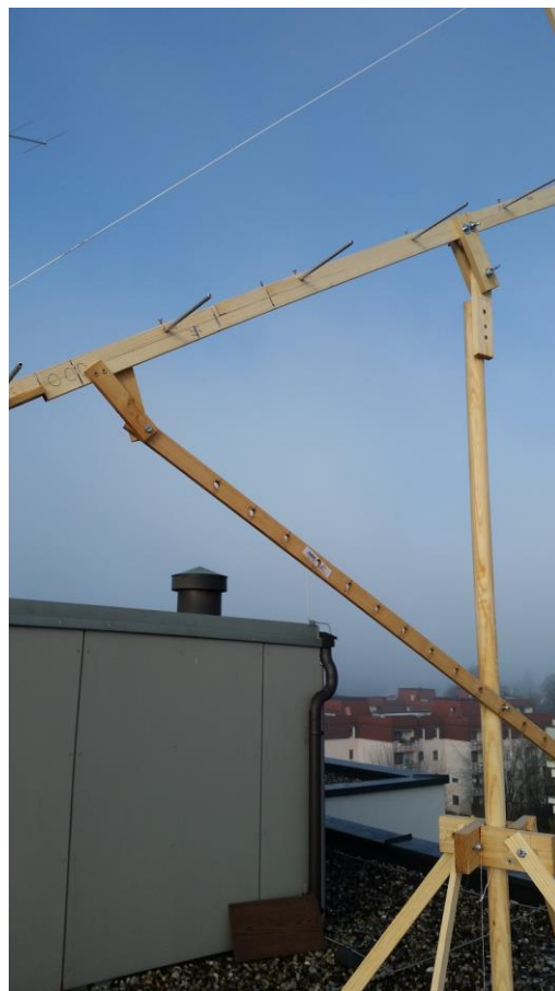
Fot. 9.6. 23-elementowa antena Yagi ma zysk 18,6 dB, co odpowiada antenie parabolicznej o średnicy 2,6 m przy sprawności 50%
