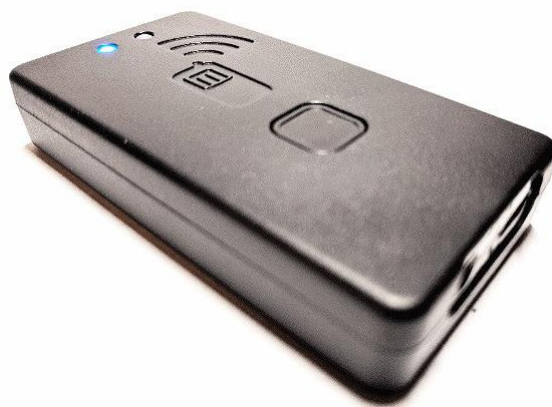
Fot. 3.2.4. Modem Mobilink TNC posiada złącze Bluetooth
