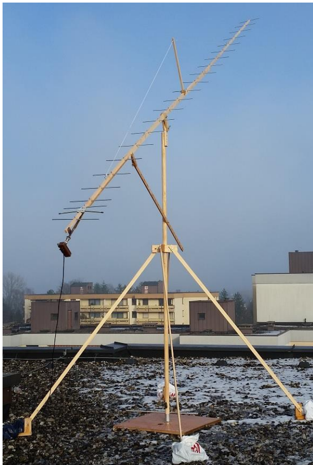
Fot. 9.6. 23-elementowa antena Yagi ma zysk 18,6 dB, co odpowiada antenie parabolicznej o średnicy 2,6 m przy sprawności 50%
