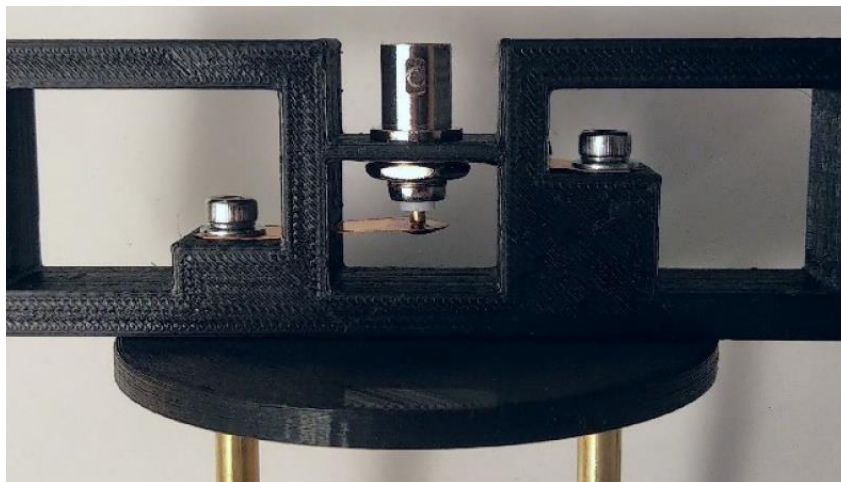
Fot.13.3. Połączenie prętów z gniazdkiem BNC
