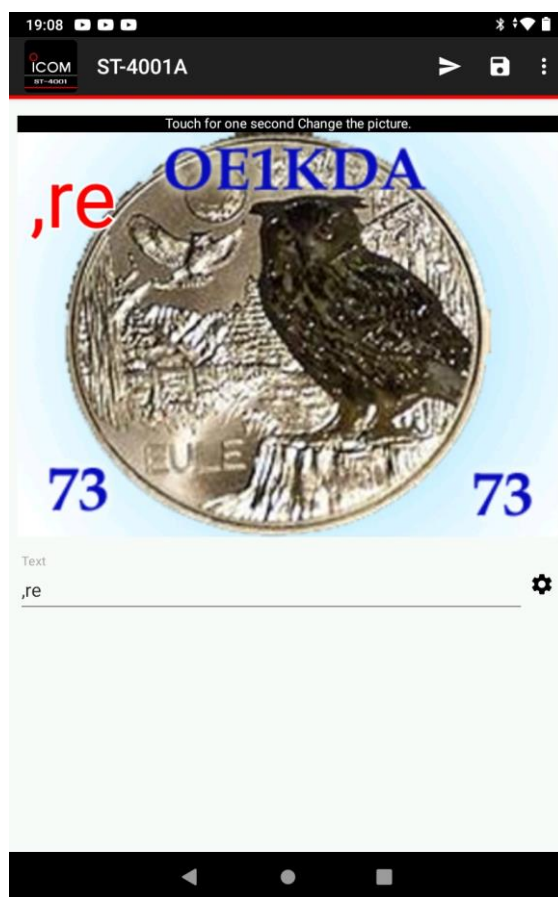
Rys. 2.3.3. Okno główne ST4001A. Pod symbolem wielokropka znajduje się konfiguracja złączy WiFi i BT, a pod symbolem trybika – modyfikacja właściwości tekstu
