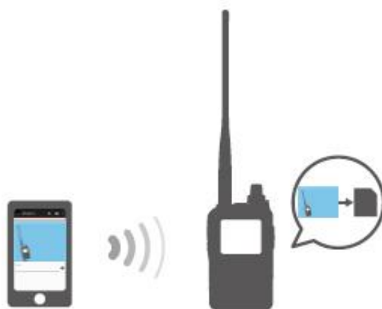
Rys. 2.3.1. Transmisja danych z ST4001A do ID-52
